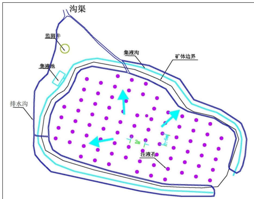
图 6.4-1 各矿块的清污分流示意图
